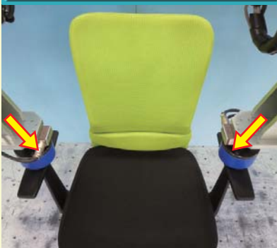
肘掛けの 中心垂直力静荷重試験
