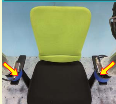
肘掛けの 前部垂直力静荷重試験
