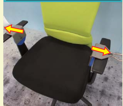
肘掛けの 側方静荷重試験
