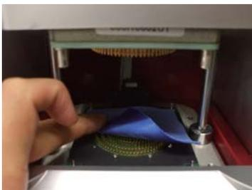
肌側面に水分を滴下し、外側面に向けて浸透・拡散する様子を電氣的に測定するため、表裏で加工の異なる生地や、多層構造の素材の生地も評価することができます。
