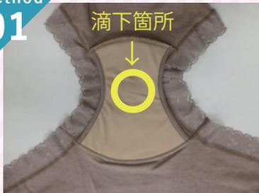
パッドに水を5mlずつ滴下し、裏側への染み出しを調べる。
