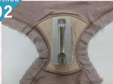
パッドに人工尿を5ml滴下しては1分間放置し、滴下部にアクリル板、錘(おもり)の順にのせ、1分間50g/cm<sup>2</sup>の荷重を掛けることを繰り返し、裏側への染み出しを調べる。
