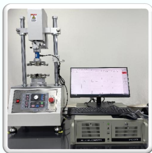
◎スライダ引手ねじり強度試験
